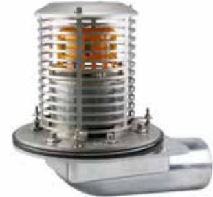
Bei der LORO-X Haupt-Not-Kombi Retentions-Attikaentwässerung mit dem für LORO patentierten Rohr-in-Rohr Prinzip bildet die obere Kante des äußeren Retentionsrohres gleichzeitig die Wehrhöhe für den darauf liegenden Notablauf. Die Notentwässerung erfolgt durch das innenliegende Rohr DN 50.
